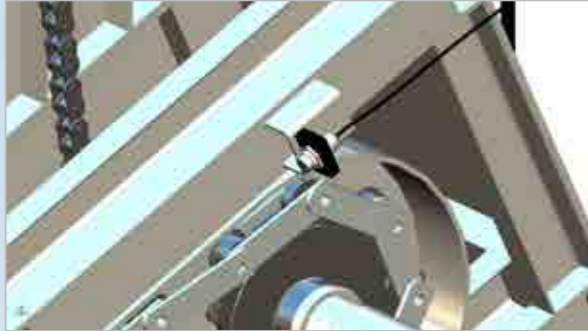
근접센서를 활용한 상하 운동 방식의 레이크로 바닥의 협잡물 인양가능 상하 운동 방식의 대형레이크
